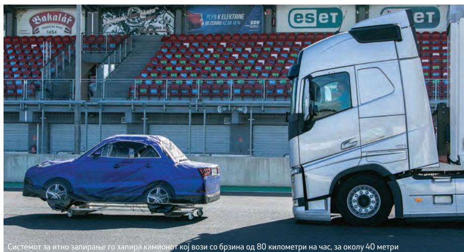
Системот за итно запирање го запира камионот кој вози со брзина од 80 километри на час, за околу 40 метри
