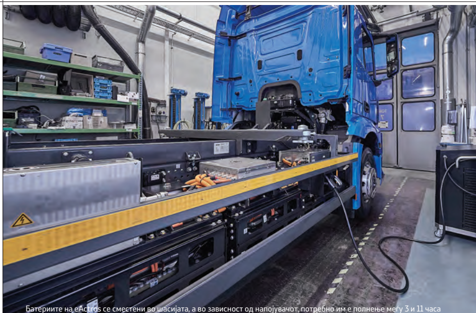
Батериите на eActros се сместени во шасијата, а во зависност од напојувачот, потребно им е полнење меѓу 3 и 11 часа
