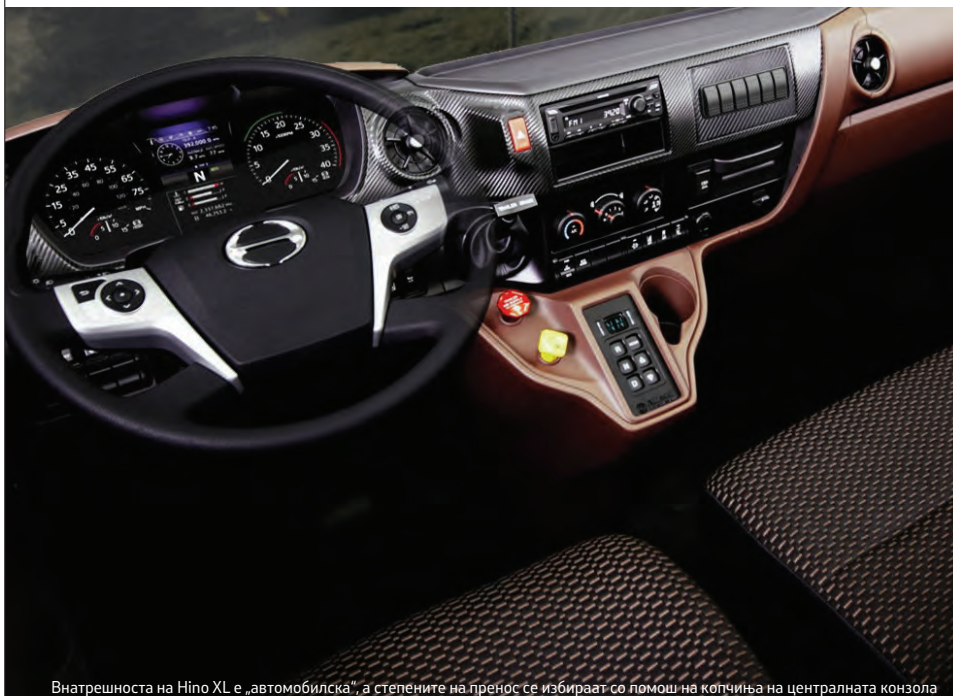
Внатрешноста на Hino XL е „автомобилска“, а степените на пренос се избираат со помош на копчиња на централната конзола
