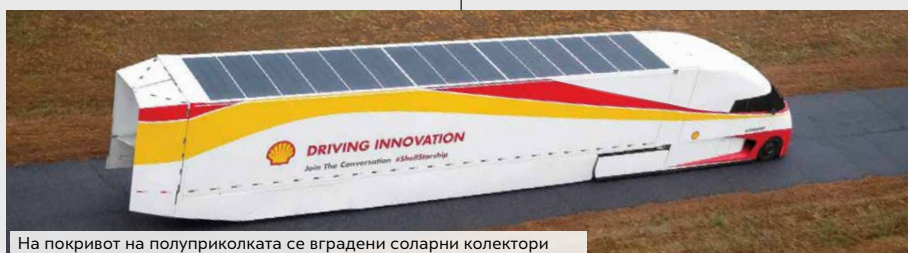
На покривот на полуприколката се вградени соларни колектори
