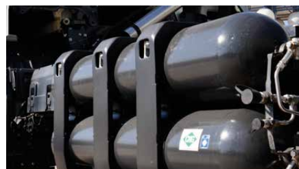
За да може без проблем да одговори на потребите на градежниците, резервоарите за метан, кај CNG-верзијата на Scania XT, се поставени повисоко на шасијата и се заштитени
