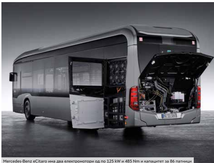
Mercedes-Benz eCitaro има два електромотори од по 125 kW и 485 Nm и капацитет за 86 патници
